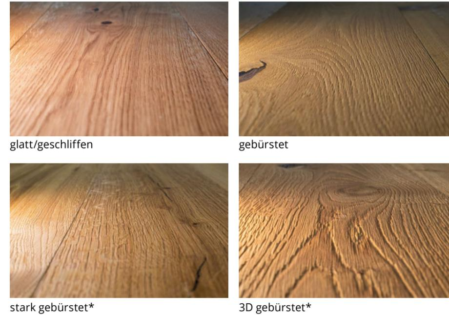
Gebürstet: Beim „Bürsten“ wird mit Nylonbürsten eine leicht fühlbare Holzstruktur in die Oberfläche eingearbeitet.
