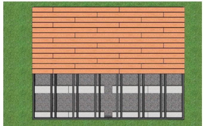
Unterbau, UK und Deck bei 1/3 Längenversatz. Achismaße: 500-117-500-117-500..mm
