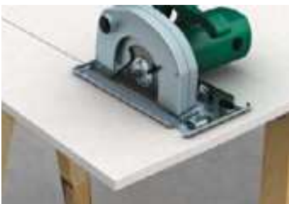
Sägen mit Handkreissäge (Drehzahl regulierbar)
