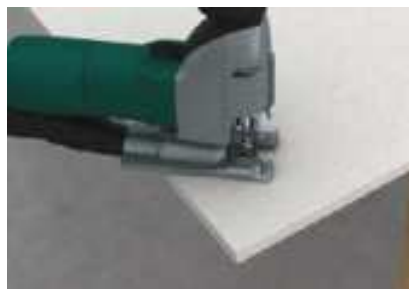
Sägen mit elektrischer Stichsäge
