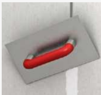
Fugen und Befestigungsmittel verspachteln
